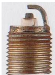
劣化したプラグ
